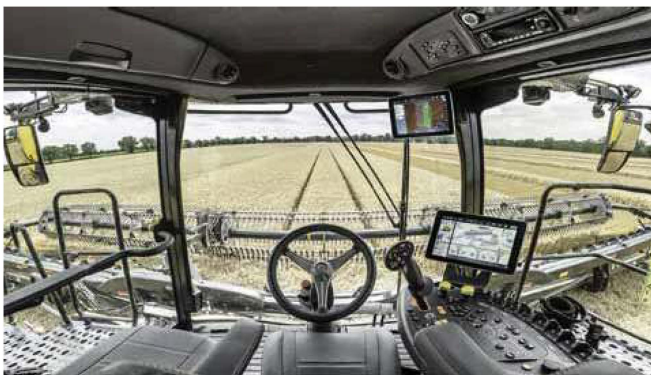
CR11 dostala najnovšiu generáciu monitora IntelliView 12. Stroj využíva a zdieľa GPS dáta pre automatickú koordináciu až 6 kombajnov na poli. Úrodové mapy môžu byť k dispozícii na úrovni jednotlivých zložiek získaných z NIR senzora.
