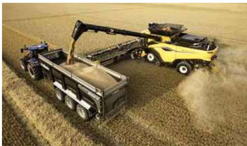
Výkonnosť vyprázdňovania 210 l.min -1 z 20 000 l zásobníka odobere zrna za 95 sekúnd.
