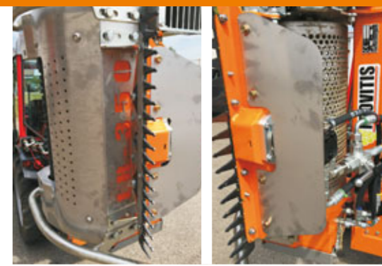
Přední žací lišta (volitelně) Žací lišta, která může být vypnuta, pokud není potřeba.
